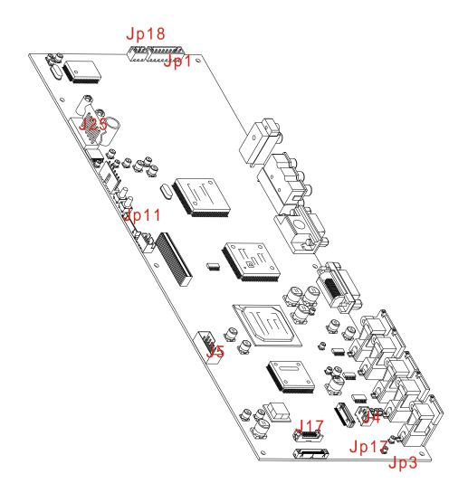
1.J17 TO PANEL 2.JP17, JP3 TO TUNER BOARD 3.J25 TO DC POWER 4.JP11 TO KEYPAD 5.J4 TO AMPLIFIER BOARD 6.J5 TO RS232 CONNECTOR
